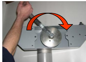
8 Jetzt sind die Antriebswelle und das Untersetzungsgetriebe von der Umlenkrolle entblockt und man kann mit dem manuellen Antrieb der Abdeckung fortfahren.
