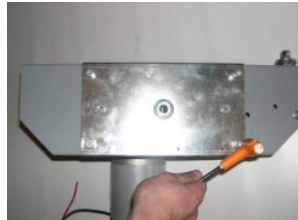
1 Die 4 Schrauben der Schutzabdeckung mit einem 6-mm-Inbusschlüssel aufschrauben
