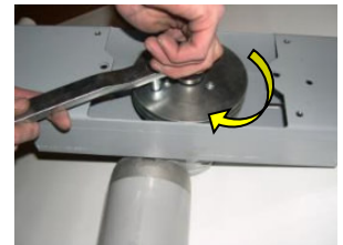
6 Notfallkurbel in der Mitte der Antriebswelle anschrauben. Vorsicht: Runden Stift in den geeigneten Sitz hineinstecken
