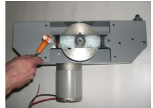
3 Mit demselben Inbusschlüssel beide Schrauben des Verstärkungsbügels der Antriebswelle aufschrauben.
